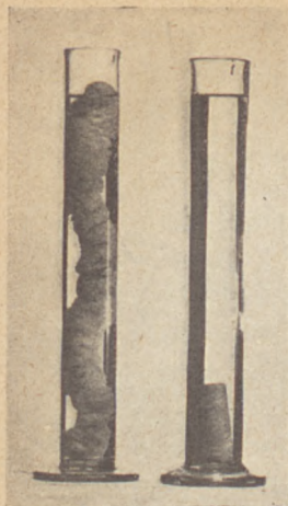
(a) (Na prawo). Benzen nie działa na ściśniętą bawełnę, zanurzoną do naczynia z benzenem, ponieważ bawełna go nie pochłania. Ta sama bawełna, zanurzona w wodzie (na lewo) znacznie powiększyła swą objętość.
