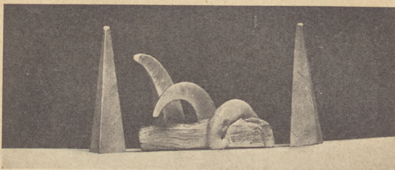
(a) Stożki Segera. Są one wykonane z gliny o różnym składzie i uszeregowane tak, że zaczynają topnieć przy różnych stopniach nagrzania. Trzy środkowe stożki były już w piecu: stożek na lewo zaczął mięknąć, środkowy zgiał się, prawy upadł. Ze stanu tych trzech stożków wywnioskowano, że wypalenie naczyń, znajdujących się w piecu było dostateczne. Dwa stożki znajdujące się po bokach nie były w piecu.
