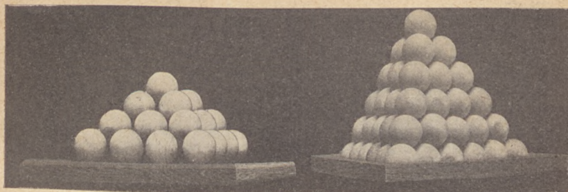
(a) Rozkład atomów żelaza w niskiej temperaturze: żelazo \alpha
