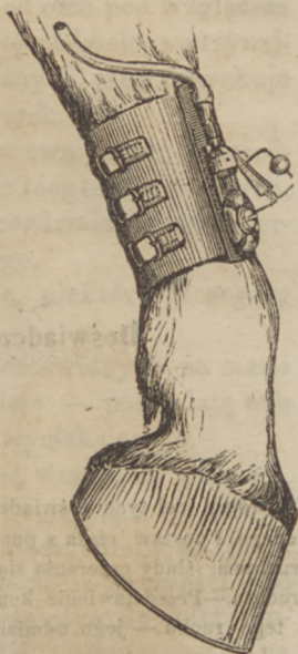
Fig. 36. Przyrząd śledzący ciśnienie kopyta końskiego na ziemię.
