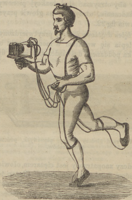
Fig. 21. Człowiek w biegu, opatrzone przyrządami kontrolującymi rozmaite ruchy.
