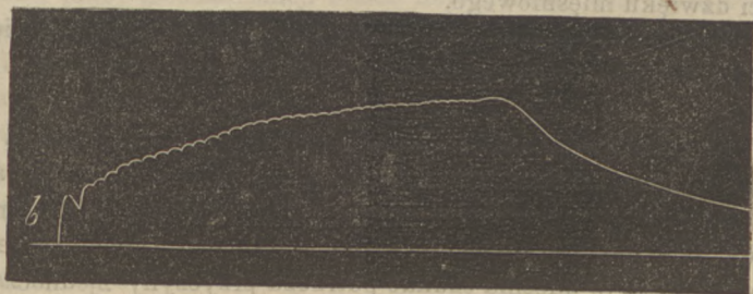
Fig. 11. Zjednoczanie się stopniowe drgań wywołanych drażnieniami elektrycznymi, powtarzającymi się z wzrastającą szybkością.
