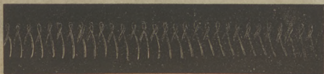
Fig. 72. Ślad graficzny pręcika Wheatstone'a, zastosowanego do oktawy, opatrzonego skrzydłem osy, i pomieszczonego w ten sposób, aby kreślił głównie górną obręczkę ósemki.
