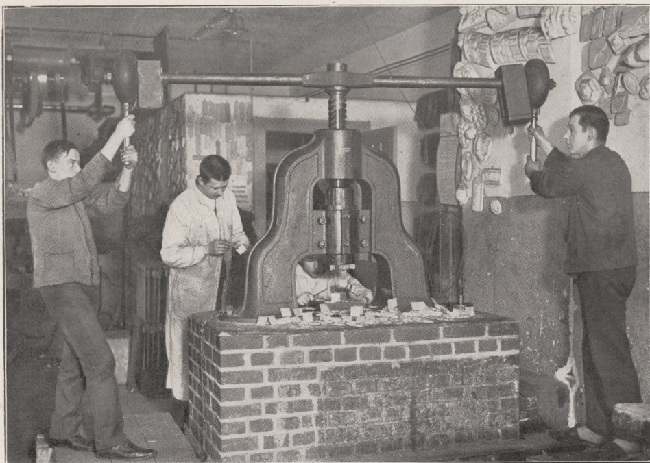
Von der Herstellung des Eisernen Kreuzes: Das Prägen der Silberblechstücke mittels einer Spindelpresse.
