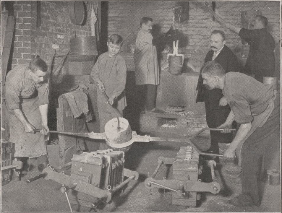
Von der Herstellung des Eisernen Kreuzes (Aufnahmen von H. Sennecke, Berlin): Das Gießen des flüssigen Eisens in die Formen.
